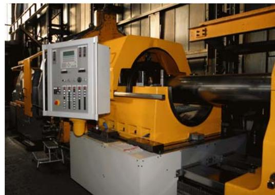
*Führungsschlitten mit neuer Bedientafel*
