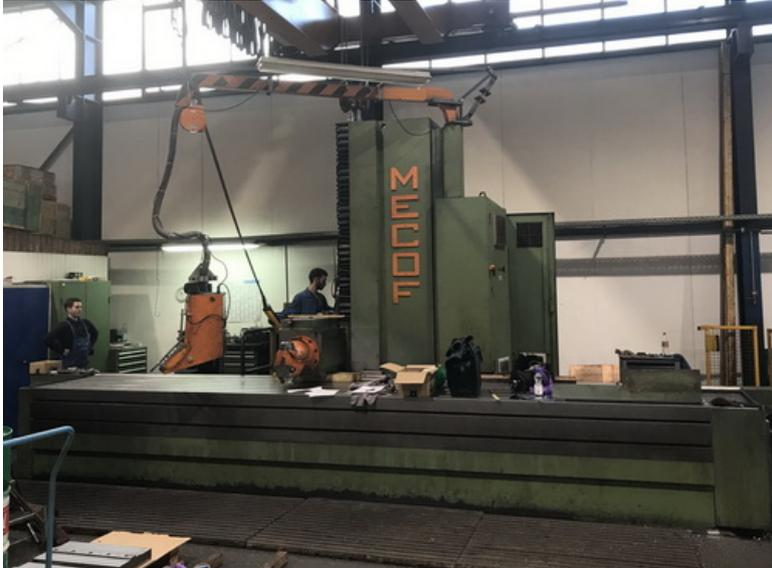
*Die Fahrständerfräsmaschine vor der Modernisierung*
